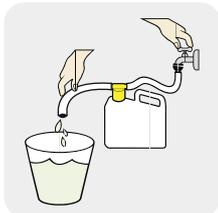
Para garantir a diluição segura é importante verificar a pressão de água recomendada entre 200 a 700 litros/hora para não comprometer a eficácia e o efeito biocida do produto. O sistema funciona com variação de precisão de +/- 10% na taxa de dosagem.
